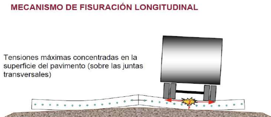
Figura 4. Alabeo del paño del pavimento rígido. La carga que se transmite a través de las ruedas, tienden a romper al pavimento en el eje longitudinal, al centro de la losa. Sacado de la Tesis de Maestría del Ing. Christian Rojas. Bolivia: “Estudio de Desempeño del pavimento Rígido Ancavari-Huachacalla Mediante Análisis Estructural por Elementos Finitos”
